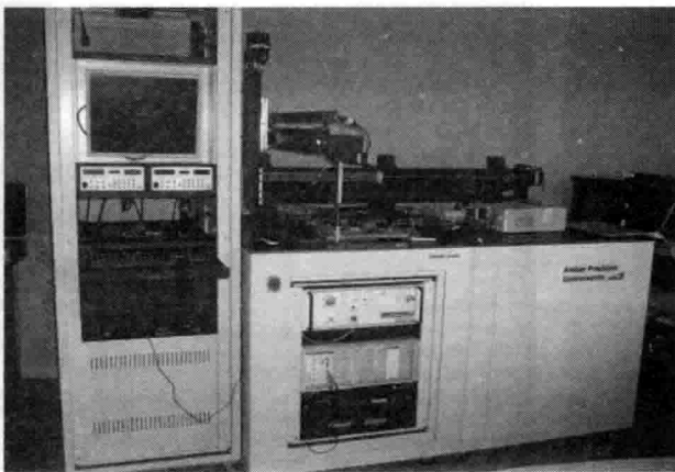
图 6.20 EMC/ESD 扫描系统。许可授权自 Amber Precision Instruments, Inc.
