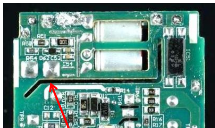
高压隔离槽，能有效增加防爬弧距离，防止污染降低绝缘性
