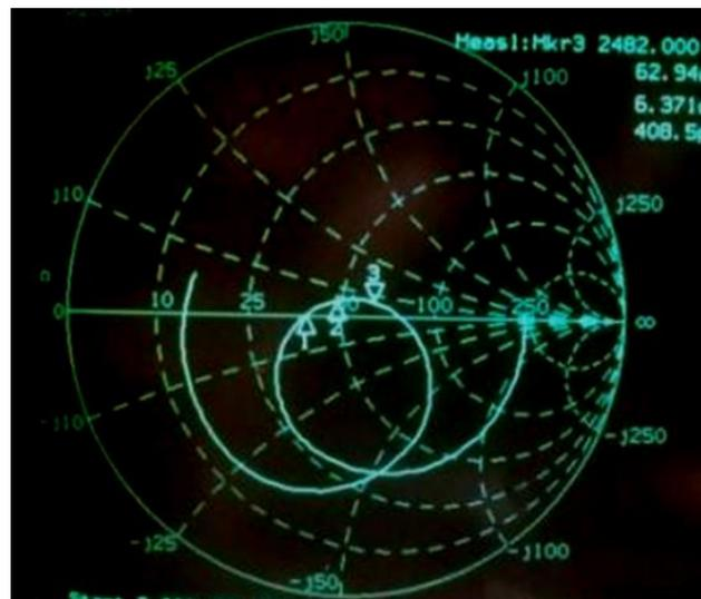
Figure 45 也显示了频率分别为 2402 MHz、2440 MHz 和 2480 MHz 的标志点 1、2 和 3 接近 Smith 图表上的 (50,0) 点。此图显示的是一个良好的匹配。
